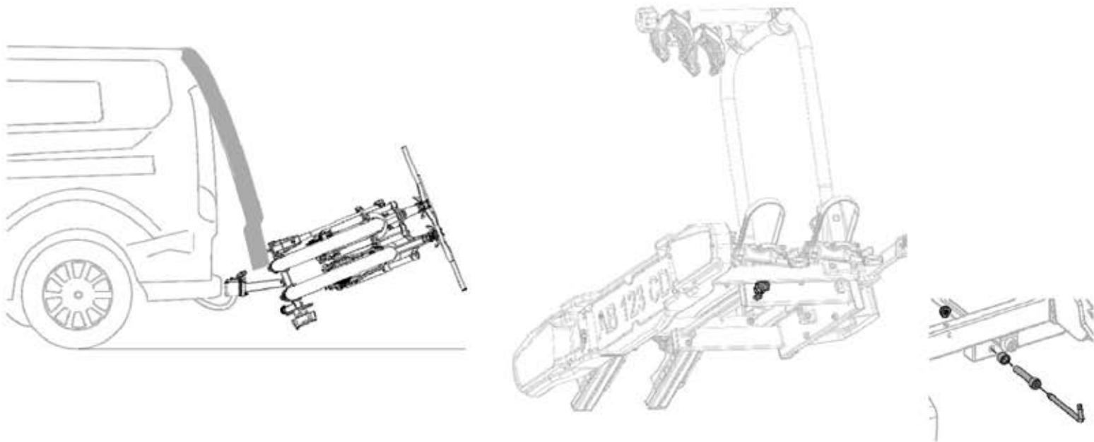
(SK) Odstránením zárazky otáčania môžete produkt viac nakloniť, sprevádzať bicykle, aby ste predišli poškodeniu.
