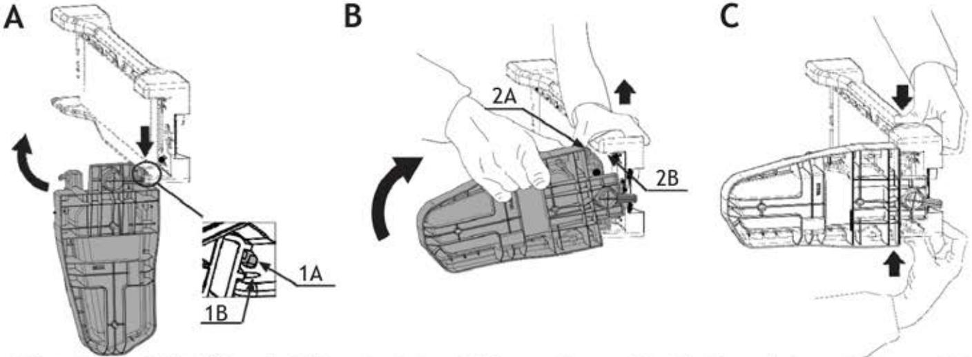
(SK) Vložte kolík 1A do otvoru 1B držiaka ŠPZ, otočte držiak svetla tak, aby sa kolík 2A zasunul do otvoru 2B (obrázok B), v prípade potreby mierne potiahnite držiak ŠPZ, keď je v polohe, zatlačte na ŠPZ držiak, ako je znázornené na obrázku C, aby kolíky zapadli.
