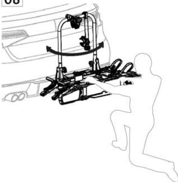
(SK) Skontrolujte, či sa nosič bicyklov neotáča, ak je výrobok upevnený, pokračujte krokom 10 v opačnom prípade prejdite na krok 09 a nastavte uzamykací systém. (ES) Compruebe si el portabicicletas no gira, si está fijo, pase al paso 10, de lo contrario pase al paso 09 para ajustar el sistema de bloqueo.
