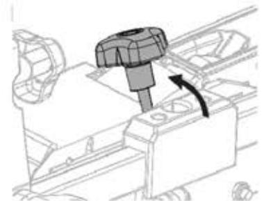
SK Ak chcete nosič nakloniť a dostať sa do kufra, odskrutkujte ručičku v strede a posuňte ju preč z drážky, potom nosič nakloňte rukou, kým sa nezastaví. Opakujte opačný krok, aby ste ho vrátili na miesto. Pred každým použitím sa uistite, že je gombík pevne priskrutkovaný.
