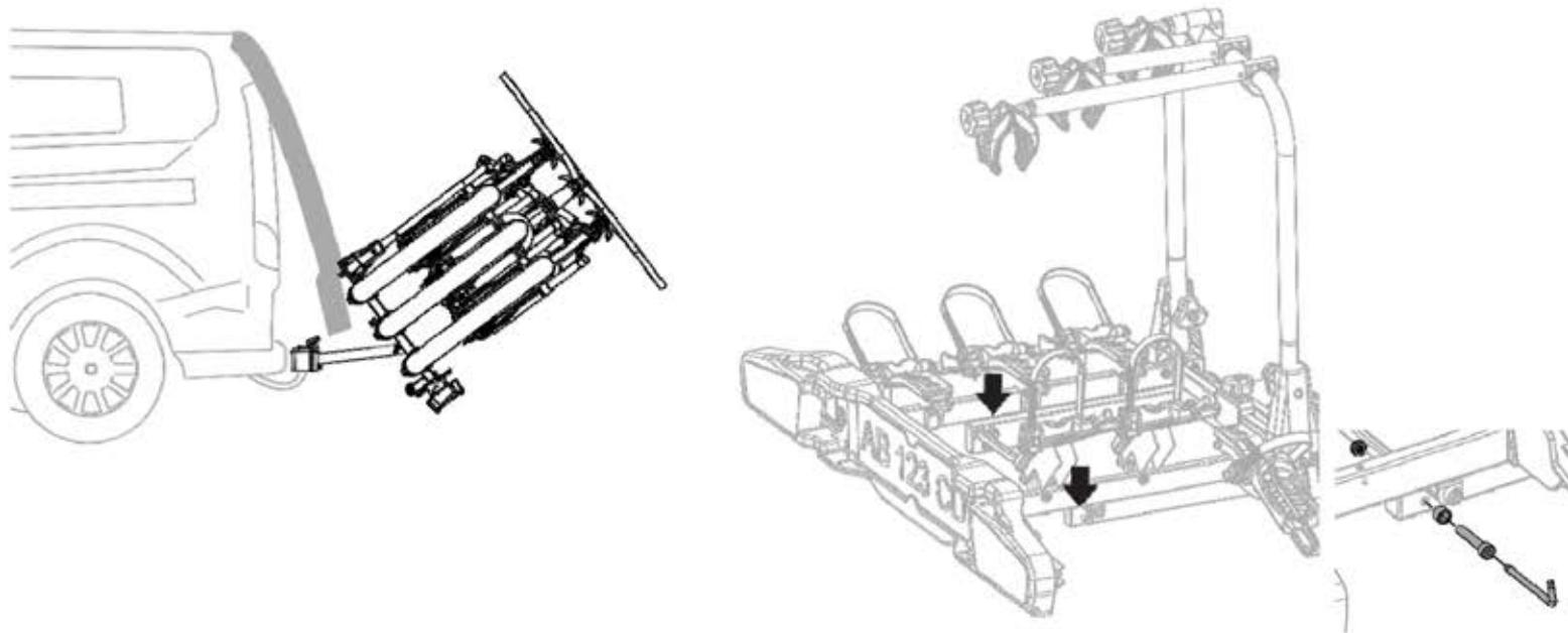
(SK) Odstránením zarážky otáčania môžete produkt viac nakloniť, pridržte bicykle, aby ste predišli poškodeniu.
