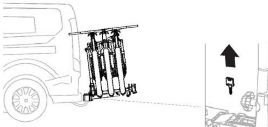
(SK) V prípade vozidla s dlhými dverami batožinového priestoru vždy pred ich otvorením vyberte klúč.
