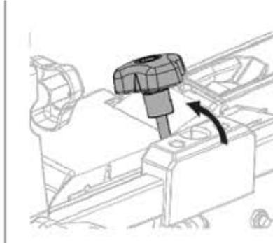
SK Ak chcete nosič nakloniť a dostať sa do kufra, odskrutkujte gombík v strede a posuňte ho preč z drážky, potom ho nakloňte rukou, kým sa nezastaví. Opakujte opačný krok, aby ste ho vrátili na miesto. Pred každým použitím sa uistite, že je gombík pevne priskrutkovaný.
