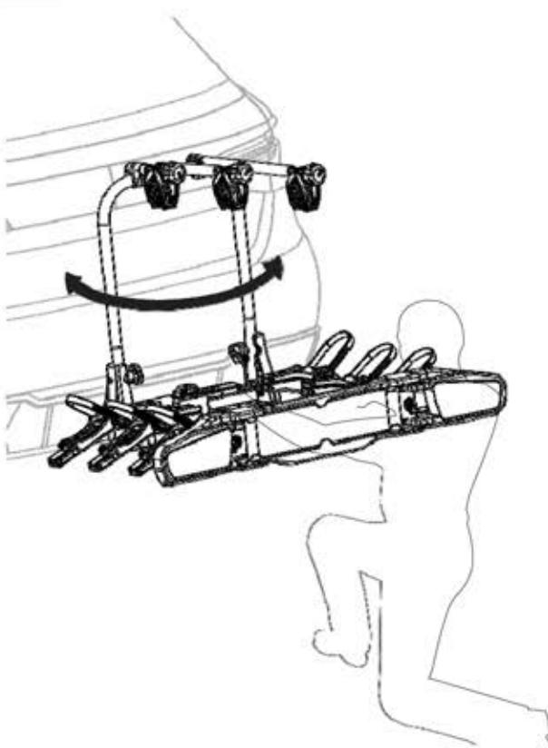
(SK) Skontrolujte, či sa nosič bicyklov neotáča, ak je výrobok upevnený, pokračujte krokom 10 v opačnom prípade prejdite na krok 09, aby ste nastavili systém uzamykania.
