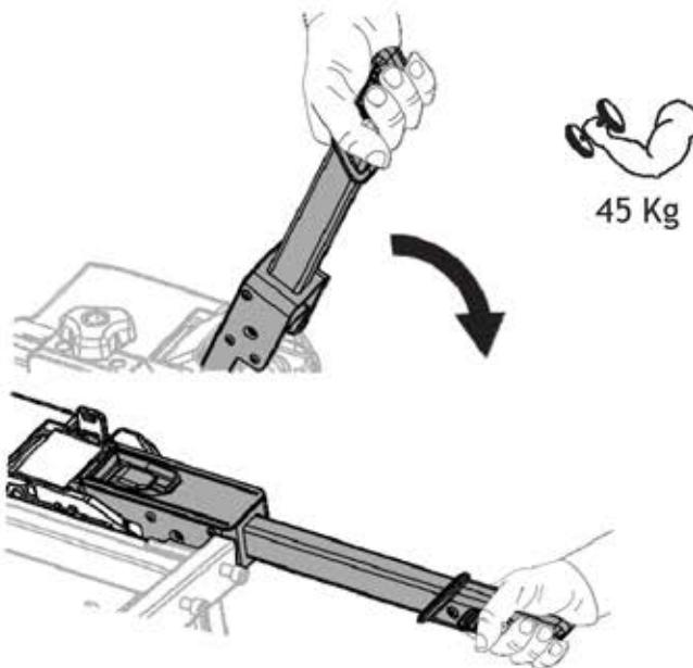
(SK) Na zvýšenie uzaváracej sily ručne otočte skrutku o 1/4 otáčky, potom sklopte páku a skontrolujte dotiahnutie výrobku, v prípade potreby opakujte operáciu, kým nenájdete správne upevnenie.
