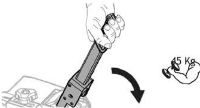
(SK) Na zvýšenie uzaváracej sily ručne otočte skrutku o 1/4 otáčky, potom sklopte páku a skontrolujte dotiahnutie výrobku, v prípade potreby opakujte operáciu, kým nenájdete správne upevnenie.
