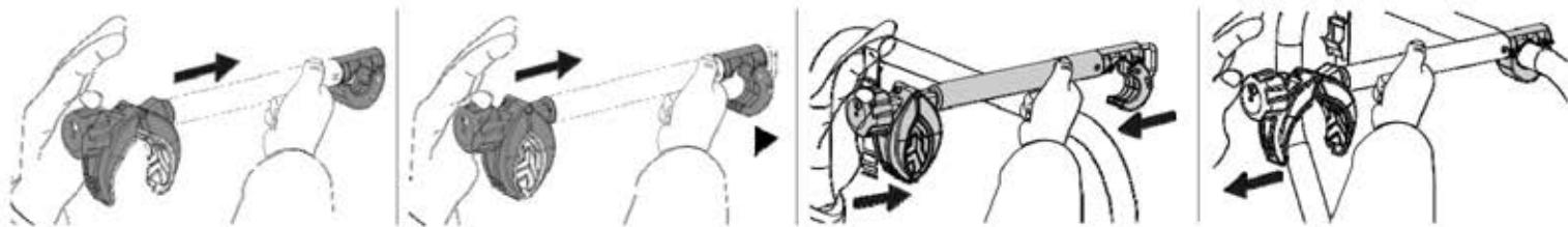
**SK** Odkrúkujte gombík o niekoľko otáčok, potom stlačte gombík, aby ste ovládali zadnú čelust', čím viac gombík odkrúkujete, tým viac sa čelust' otvori. Umiestnite rameno zámku bicykla do najvhodnejšej polohy v závislosti od tvaru rámu bicykla a potom priskrutkujte gombík, aby ste utiahli svorku rámu k bicyklu .
