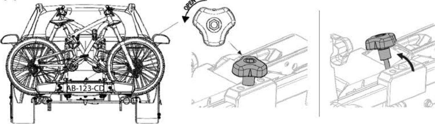
SK Ak chcete nosiť naklonit' a dostať sa do kufra, odskrutkujte gombík v strede a posuňte ho preč z drážky, potom ho nakloňte rukou, kým sa nezastavi. Opakujte opačný krok, aby ste ho vrátili na miesto. Pred každým použitím sa uistite, že je gombík pevne priskrutkovaný.
