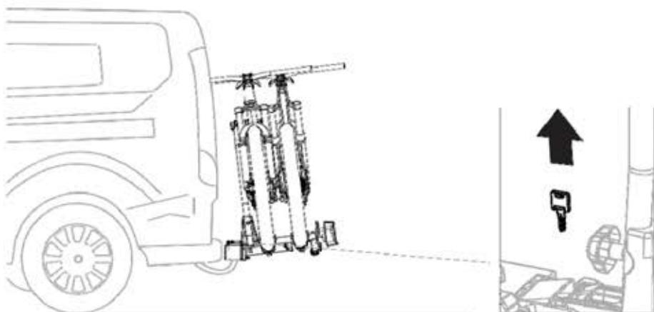
(SK) V prípade vozidla s dlhými dverami batožinového priestoru vždy pred ich otvorením vyberte kľúč. (ES) En el caso de un vehículo con portón trasero largo, retire siempre la llave antes de abrirlo. (IT) In caso di veicolo con portellone lungo rimuovere sempre la chiave, prima di aprirlo.
