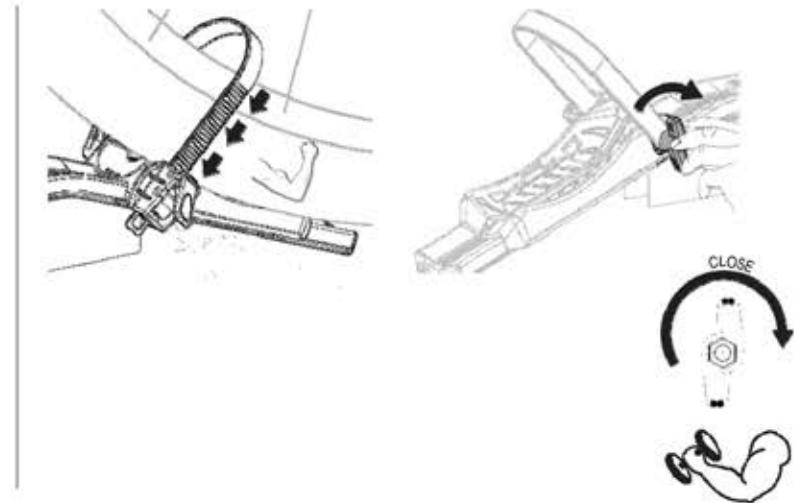
**SK** Odistite podpery kolies odkrútkovaním gombika (X), nasuňte podpery kolies na koľajnicu, čím ich prispôsobíte prepravovanému bicyklu, po nájdení správnej polohy upevnite popruh a potom gombík pevne priskrutkujte..
