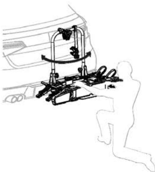
(SK) Skontrolujte, či sa nosič bicyklov neotáča, ak je výrobok upevnený, pokračujte krokom 10 v opačnom prípade prejdite na krok 09, aby ste nastavili systém uzamykania.
