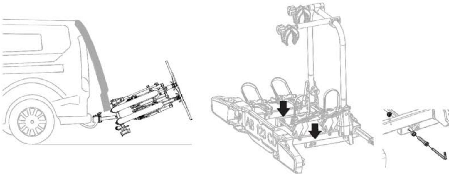
(SK) Odstránením zarážky otáčania môžete produkt viac nakloniť, pridržte bicykle, aby ste predišli poškodeniu.
