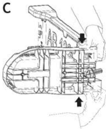
(SK) Vložte kolík 1A do otvoru 1B držiaka ŠPZ, otočte držiak svetla tak, aby sa kolík 2A zasunul do otvoru 2B (obrázok B), v prípade potreby mierne potiahnite držiak ŠPZ, keď je v polohe, zatlačte na ŠPZ držiak, ako je znázornené na obrázku C, aby kolíky zapadli.
