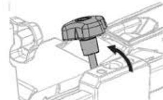
SK Ak chcete nosiť nakloniť a dostať sa do kufra, odskrutkujte gombík v strede a posuňte ho preč zo sedla, potom ho nakloňte rukou, kým sa nezastaví. Opakujte opačný krok, aby ste ho vrátili na miesto. Pred každým použitím sa uistite, že je gombík pevne priskrutkovaný.
