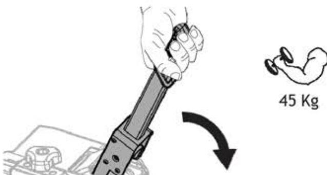
(SK) Na zvýšenie uzatváracej sily ručne otočte skrutku o 1/4 otáčky, potom sklopte páku a skontrolujte dotiahnutie výrobku, v prípade potreby opakujte operáciu, kým nenájdete správne upevnenie.
