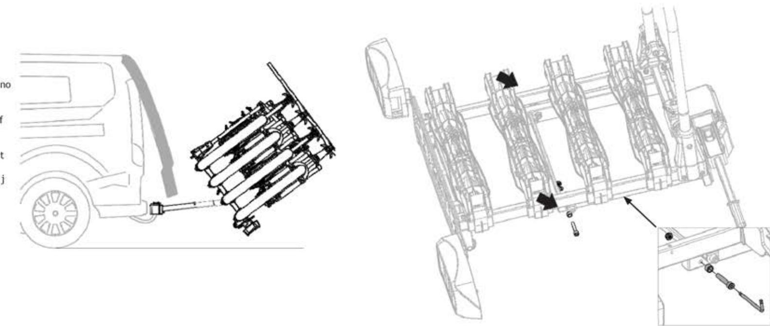
(SK) Odstránením zarážky otáčania môžete produkt viac nakloniť, pridržte bicykle, aby ste predišli poškodeniu.
